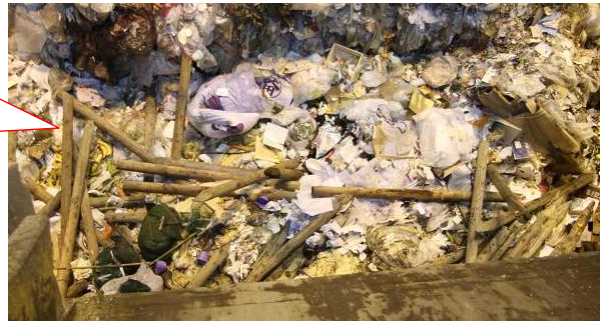
ごみバンカに投入された大量の木の杭
