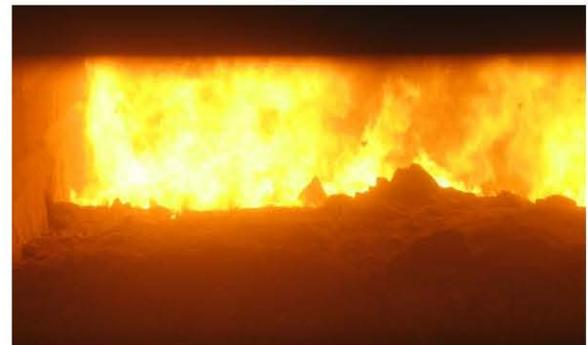
確実な焼却処理をするために、焼却炉を800℃以上の高温で24時間連続焼却運転しています。
