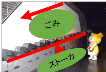
見学ルートに 設置されている 焼却炉内実物大モデル
