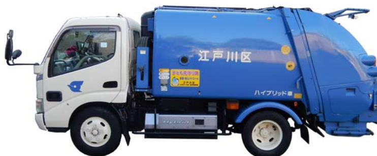
図 4.3-5 ごみ収集車両の外観（小型プレス車 4 m 3 ）
