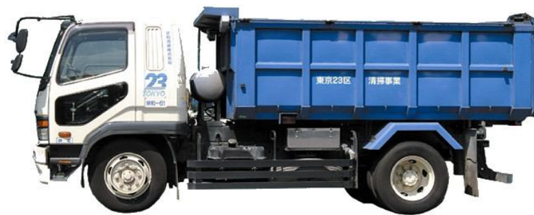
図 6.3-6 灰等運搬車両の外観（大型ダンプ車天蓋付 10m 3 ）
