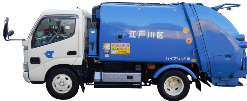
図 3.3.2-3 ごみ収集車両の外観（小型プレス車 4m 3 ）
