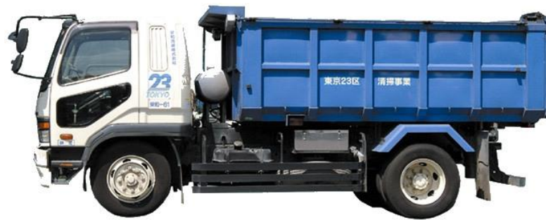
図 3.3.2-4 灰等運搬車両の外観（大型ダンプ車天蓋付 10m 3 ）
