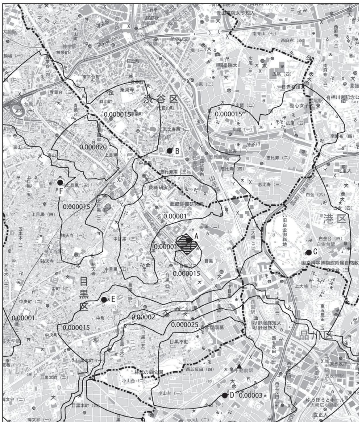
図 8.1-23(2) 施設の稼働に伴う 二酸化窒素の予測結果 (風洞実験による補正なし)
