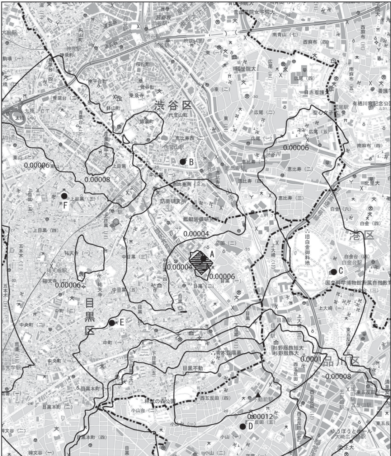
図 8.1-24 (2) 施設の稼働に伴う ダイオキシン類の予測結果 (風洞実験による補正なし)
