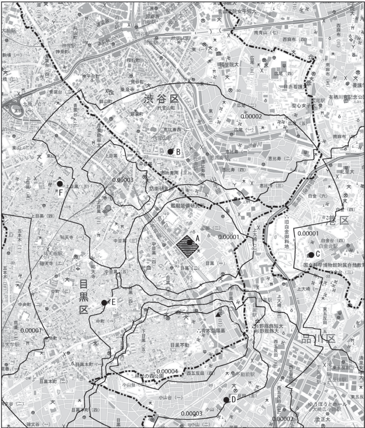
図 8.1-23(1) 施設の稼働に伴う 二酸化窒素の予測結果
