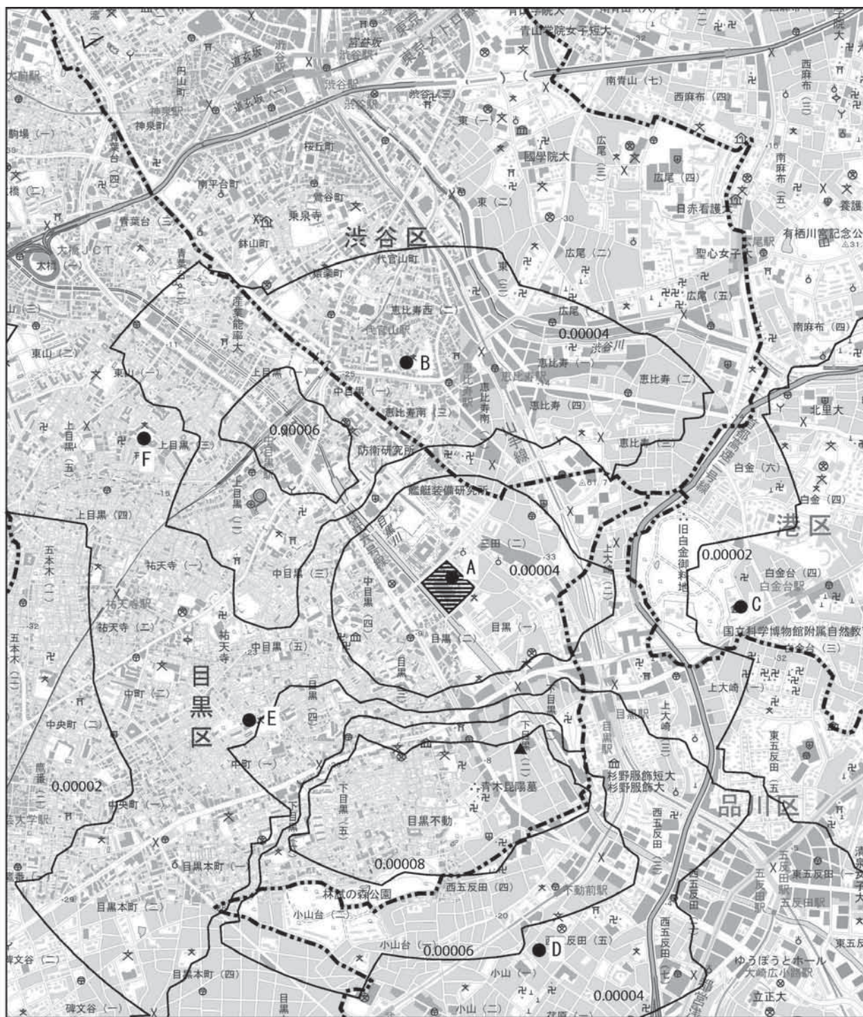
図 8.1-26 (1) 施設の稼働に伴う水銀の予測結果
