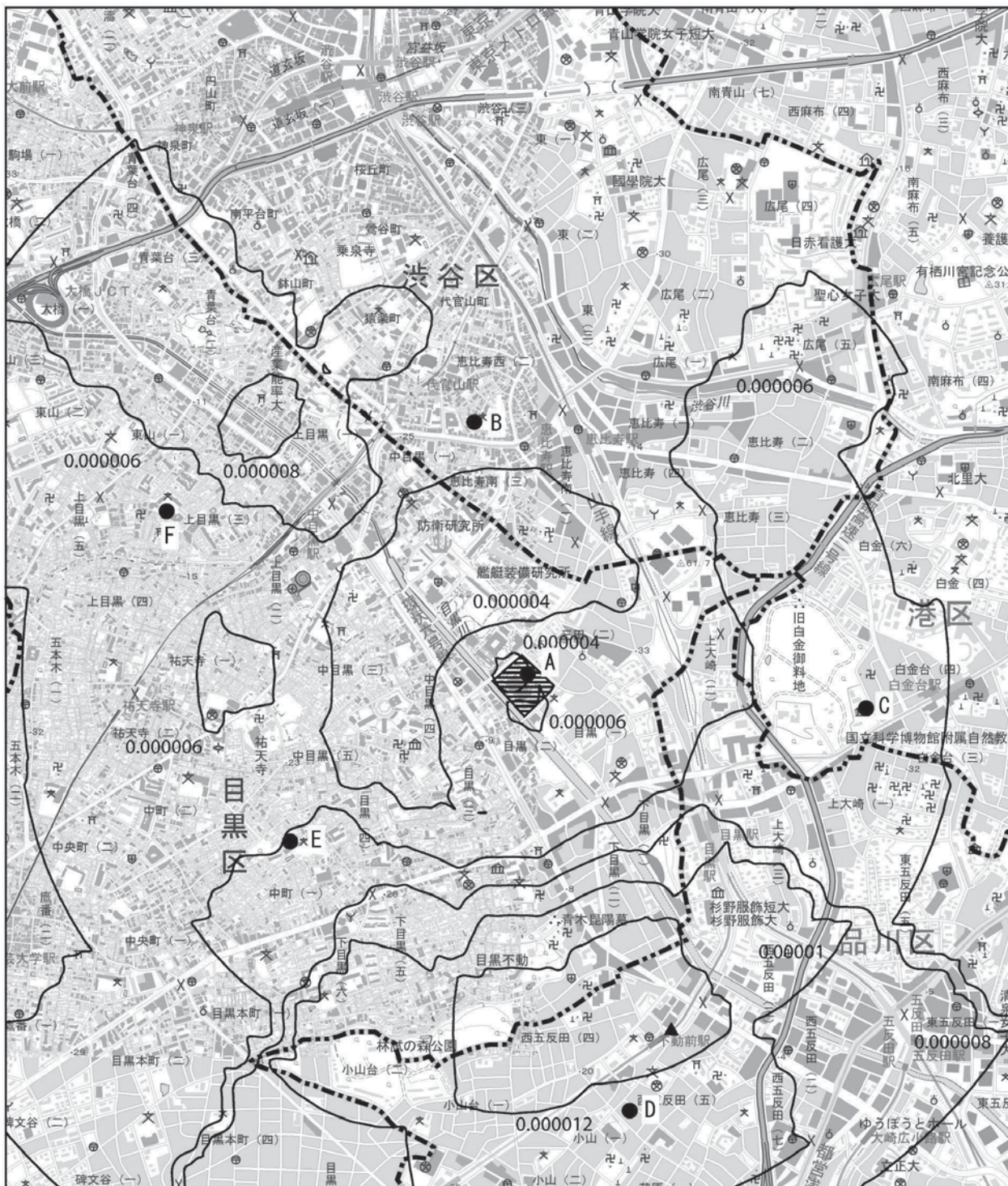
図 8.1-25 (2) 施設の稼働に伴う塩化水素の予測結果 (風洞実験による補正なし)
