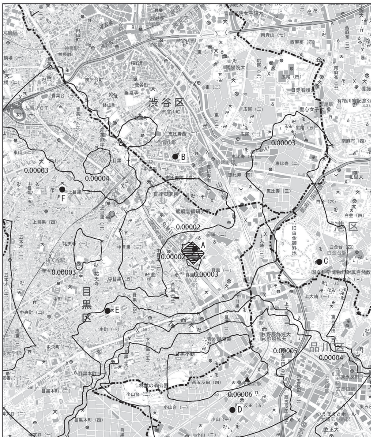
図 8.1-26(2)施設の稼働に伴う 水銀の予測結果 (風洞実験による補正なし)
