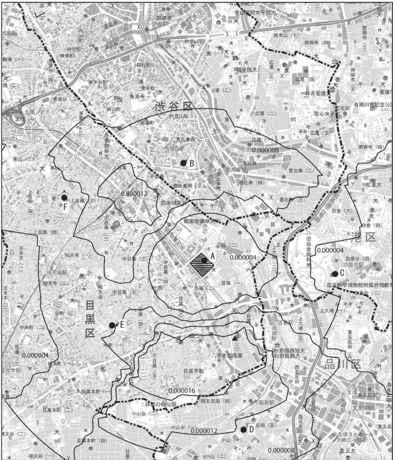
図 8.1-25 (1) 施設の稼働に伴う塩化水素の予測結果
