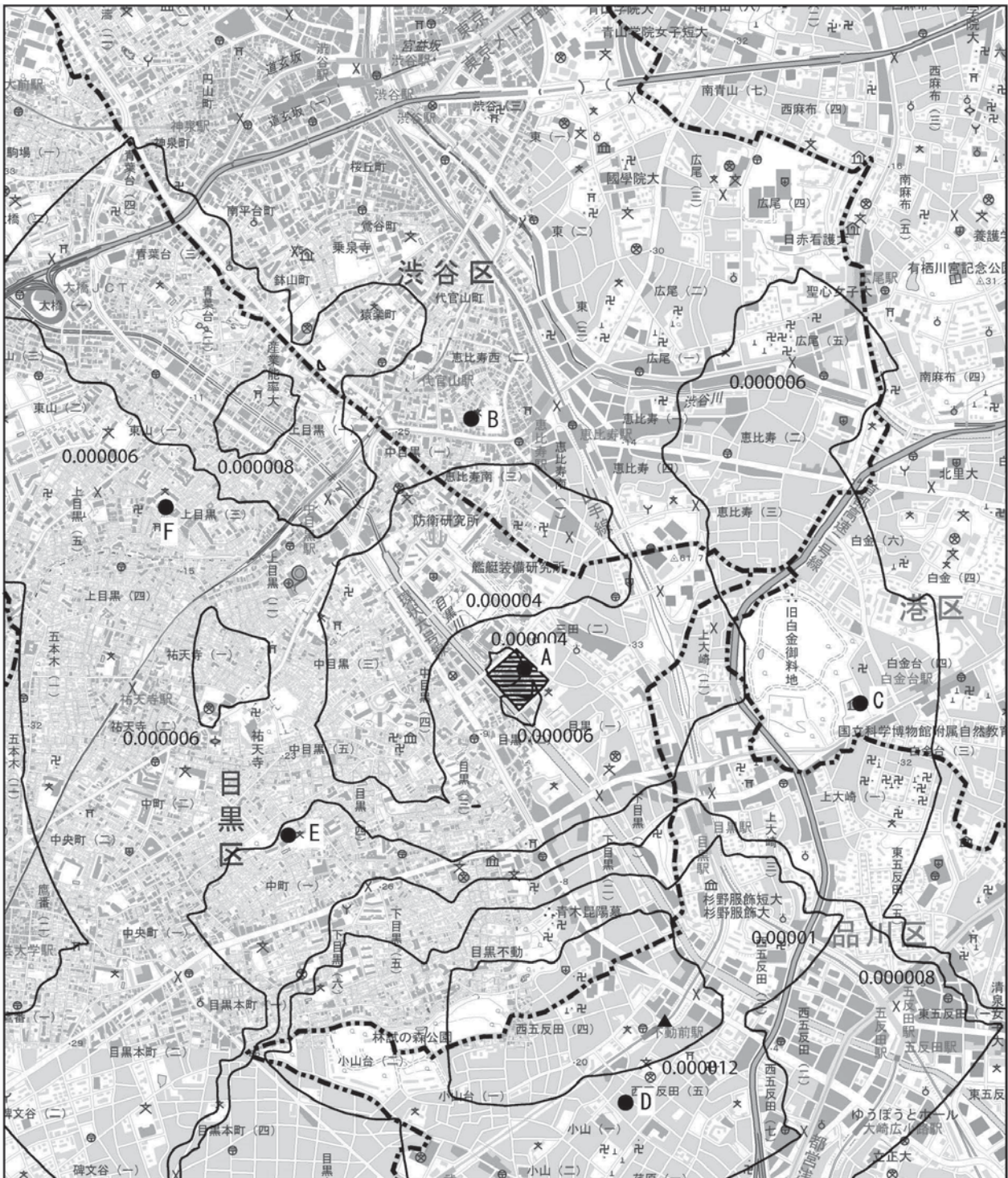
図 8.1-21 (2) 施設の稼働に伴う 二酸化硫黄の予測結果 (風洞実験による補正なし)
