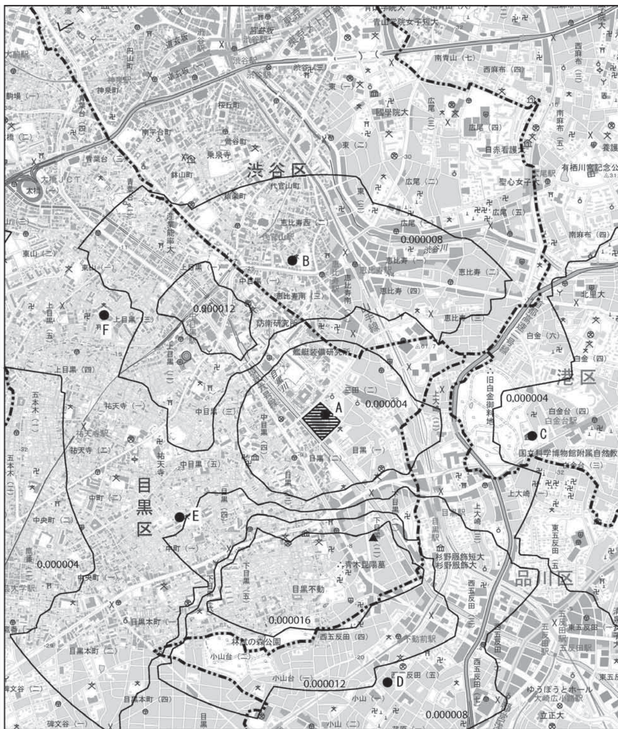
図 8.1-22(1) 施設の稼働に伴う 浮遊粒子状物質の予測結果
