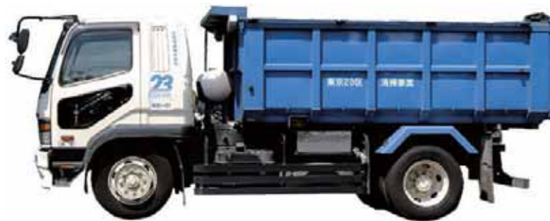
図 6.3-5 灰等運搬車両の外観（大型ダンプ車天蓋付 10m 3 ）
