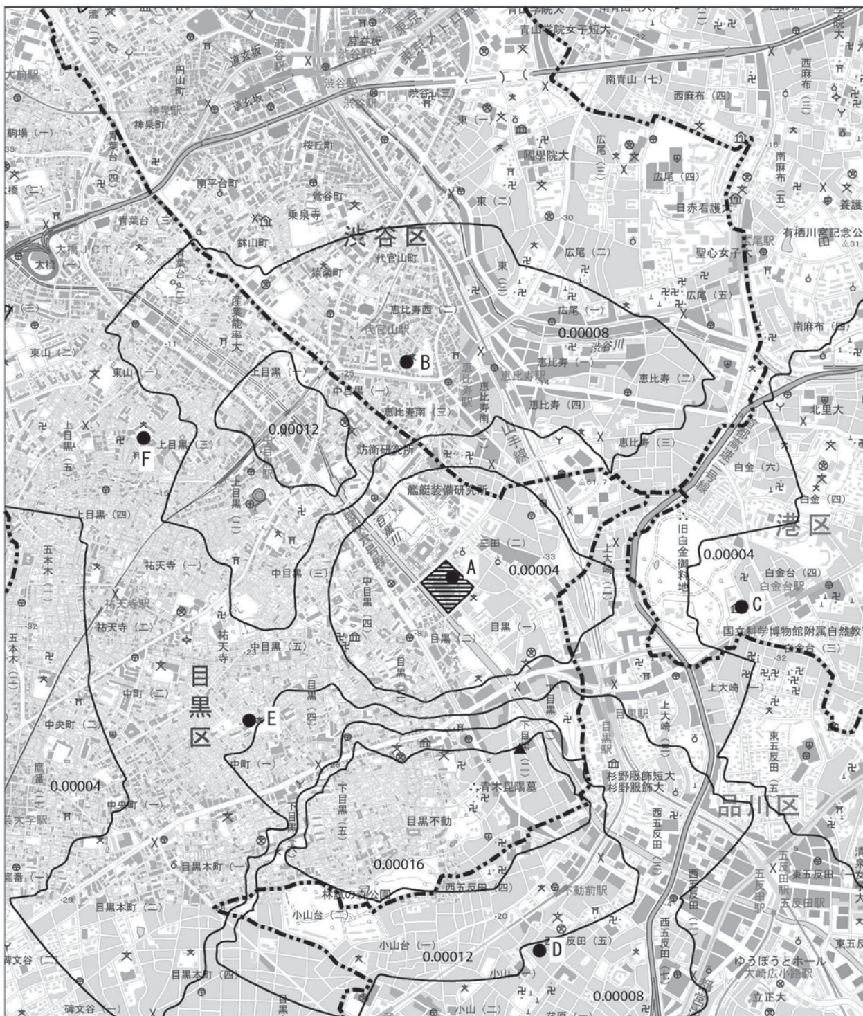
図 8.1-24(1) 施設の稼働に伴う ダイオキシン類の予測結果
