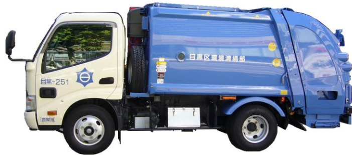
図 6.3-4 ごみ収集車両の外観（小型プレス車 4m 3 ）
