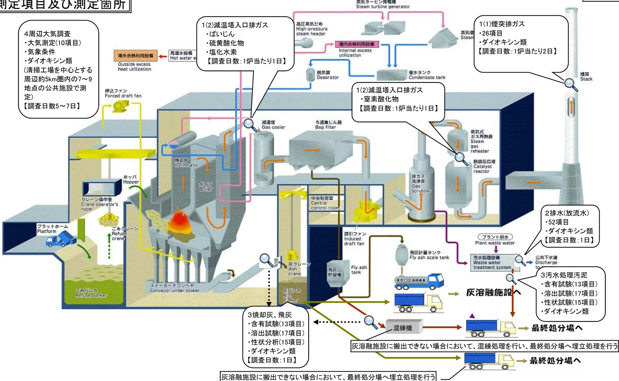
灰溶融施設に搬出できない場合において、混練処理を行い、最終処分場へ埋立処理を行う
