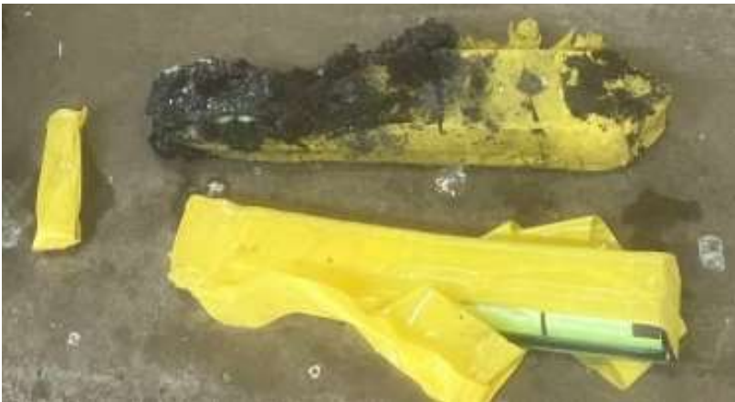
発火原因の二次電池（黄色テープで絶縁処理済）
