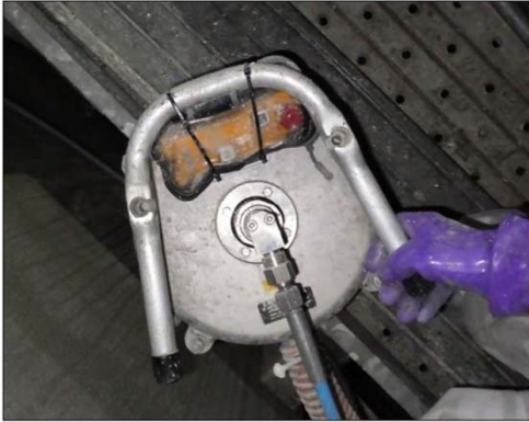
集じん装置付き超高压水洗機 (専用治具)
