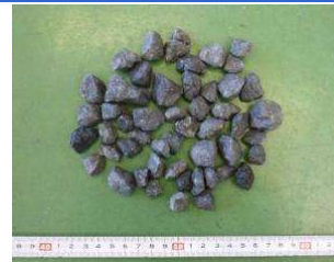
単粒度粗骨材 用途：アスファルト舗装用、 コンクリート用
