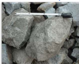
石材・割ぐり石 用途：捨石、被覆石、裏込材など
