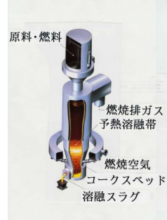
コークスベッド方式縦型溶融炉
