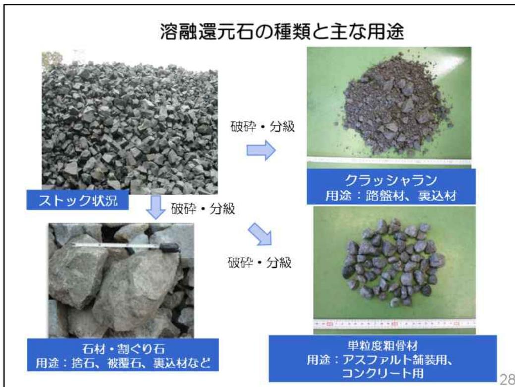
28ページでは、使用用途別による溶融還元石の大きさを写真にて比較します。
