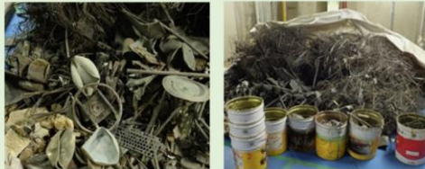
焼却炉から抽出された不燃物
