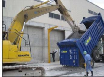
灰が固着し、ダンプアップしても降りないため、重機等を使用して掻き出すことで、想定外のコストが発生する。
