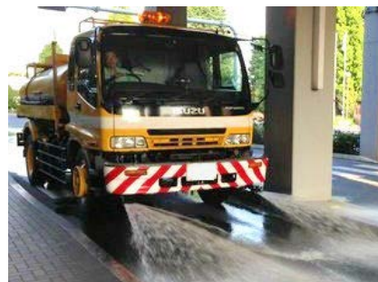
散水車による雨水利用
