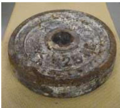
<灰コンベアに挟まっていた金属ウエイト>
