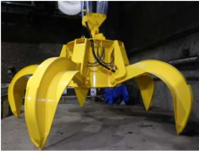
< 写真2 ごみクレーン >
