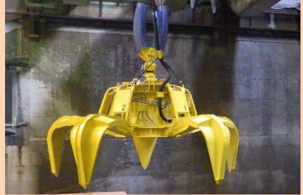
《新ごみクレーンバケット》
