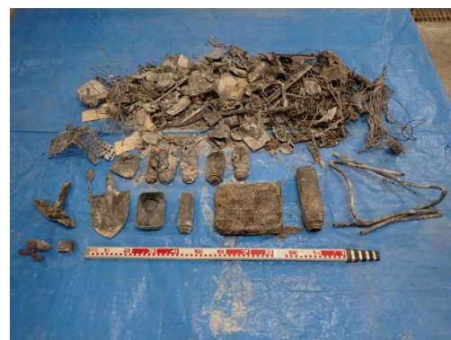
〈焼却炉から取り出された不適正ごみ〉
