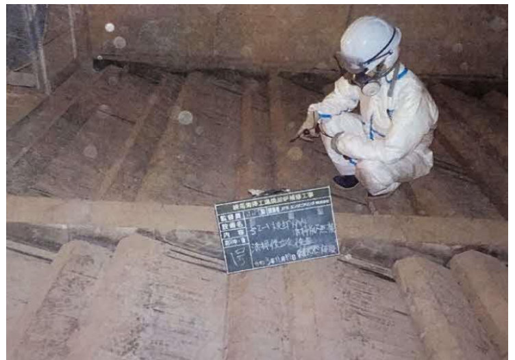
↑ 炉内の点検の様子。段々の床が火格子(ひごうし)。
