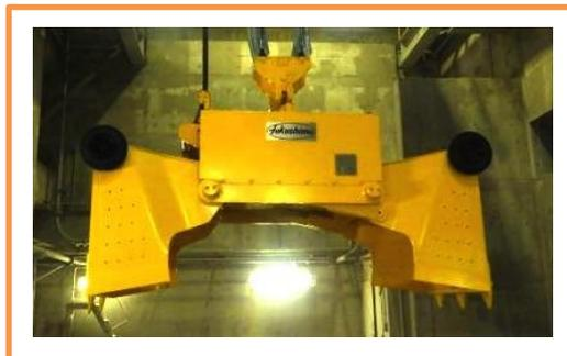
〔灰・固化物クレーンバケット（各1基）〕
