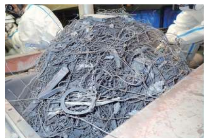
清掃工場の機械に絡まった金属類
