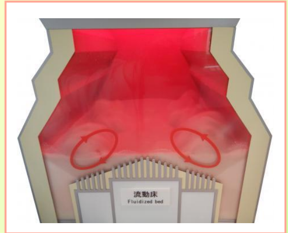
流動床式焼却炉
