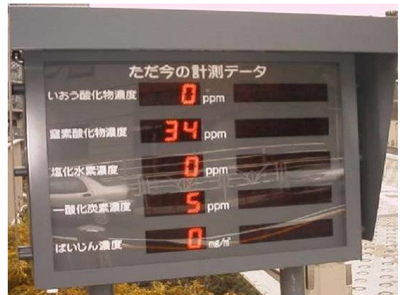
当工場の門の脇に設置している排ガス状況表示盤では、煙突から排出される排ガスの計測データを常時表示しています。
