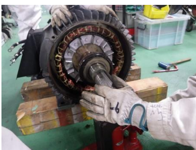
電動機の内部
