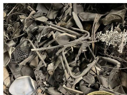
焼却炉内で詰まっていた不燃物
