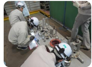
(安全弁分解立会い)
