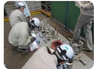
(安全弁分解立会い)
