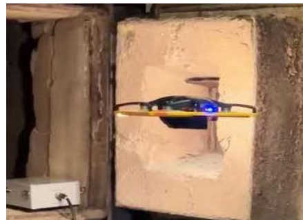
焼却炉内部の撮影に向かうドローン
