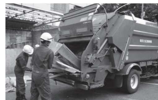
大件垃圾的转载作业（文京区）
