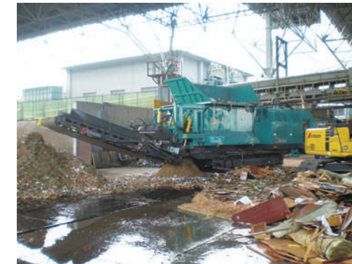
木材粗破碎机 (丸太や生木などを破碎するための機械)
