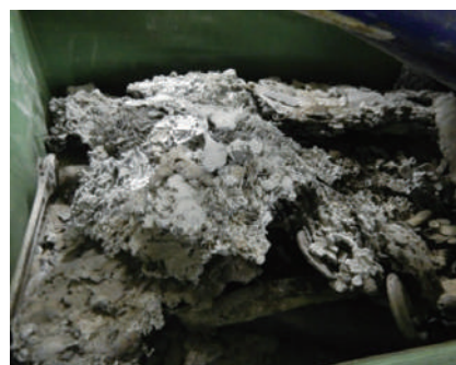
アルミニウム等の金属が溶けて固まったもの (渋谷清掃工場)
