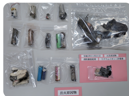
火災の原因になった二次電池
