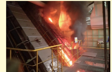
リチウムイオン二次電池によるコンベヤ火災 (中防不燃ごみ処理センター)
