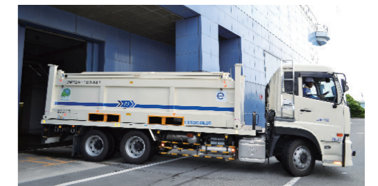
コンテナによる焼却灰搬出の様子 (新江東清掃工場)
