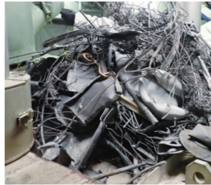
焼却炉を停止し、取り出した不燃物 (豊島清掃工場)
