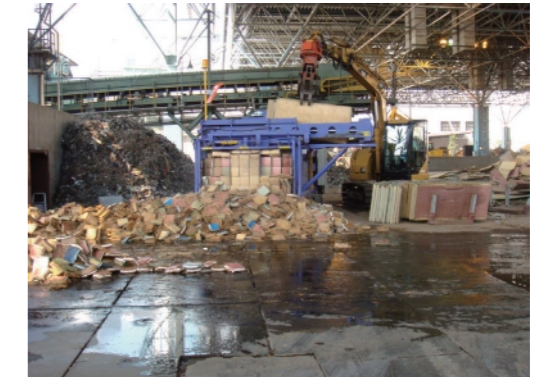
畳切断機 (畳をブロック状に切断するための機械)
