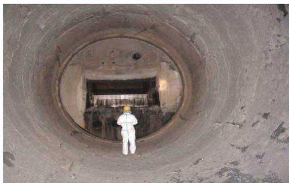
キルンの内部。直径約6m、長さ約17mあります。写真中央部に写っている職員に注目していただくと、炉の大きさは一目瞭然ですね。
