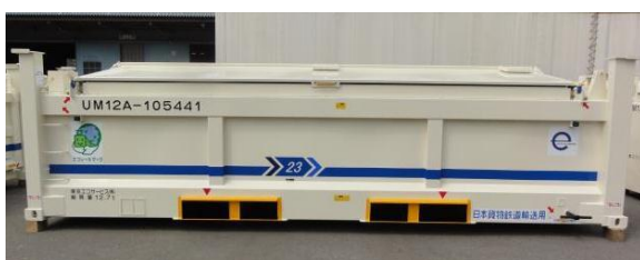
天蓋付き密閉型鉄道貨物用コンテナ (長さ 20 フィート、最大積載量 10 トン)
