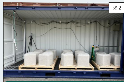
CO 2 固定実証試験
