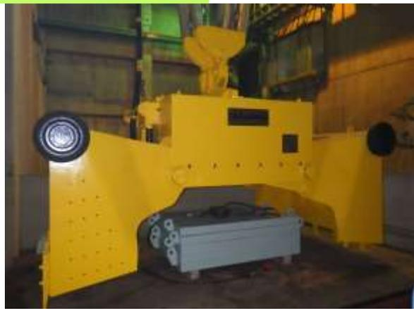
ごみの焼却により発生する灰を移動・搬出するための設備が「灰クレーン」です。劣化した部品の部分更新を行います。
