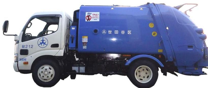
図 4-15 ごみ収集車両の外観（小型プレス車 4m<sup>3</sup>）
