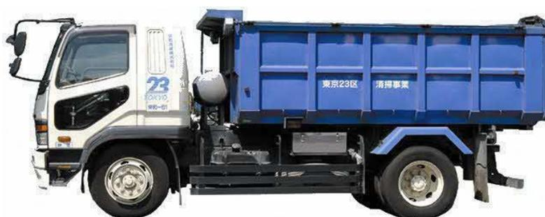
図 4-16 灰等運搬車両の外観（大型ダンプ車天蓋付 10m<sup>3</sup>）
