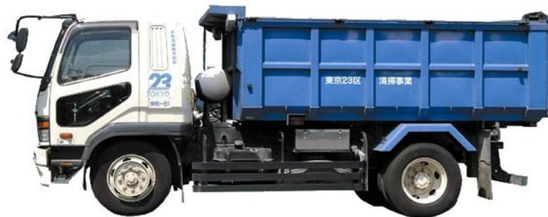
図 4.2.2-4 灰等運搬車両の外観（大型ダンプ車天蓋付 10m<sup>3</sup>）
