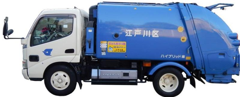
図 4.2.2-3 ごみ収集車両の外観（小型プレス車 4m<sup>3</sup>）
