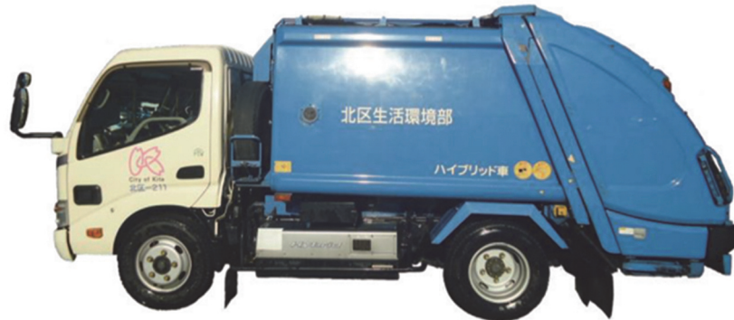
図 3.3-6 ごみ収集車両の外観（小型プレス車 4 m 3 ）
