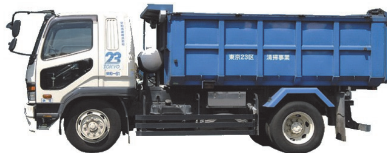
図 3.3-7 灰等運搬車両の外観（大型ダンプ車天蓋付 10m 3 ）
