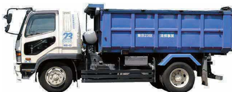
図 4.3-7 灰等運搬車両の外観（大型ダンプ車天蓋付 10m 3 ）
