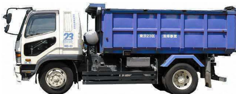
図 3.3-7 灰等運搬車両の外観（大型ダンプ車天蓋付 10m 3 ）
