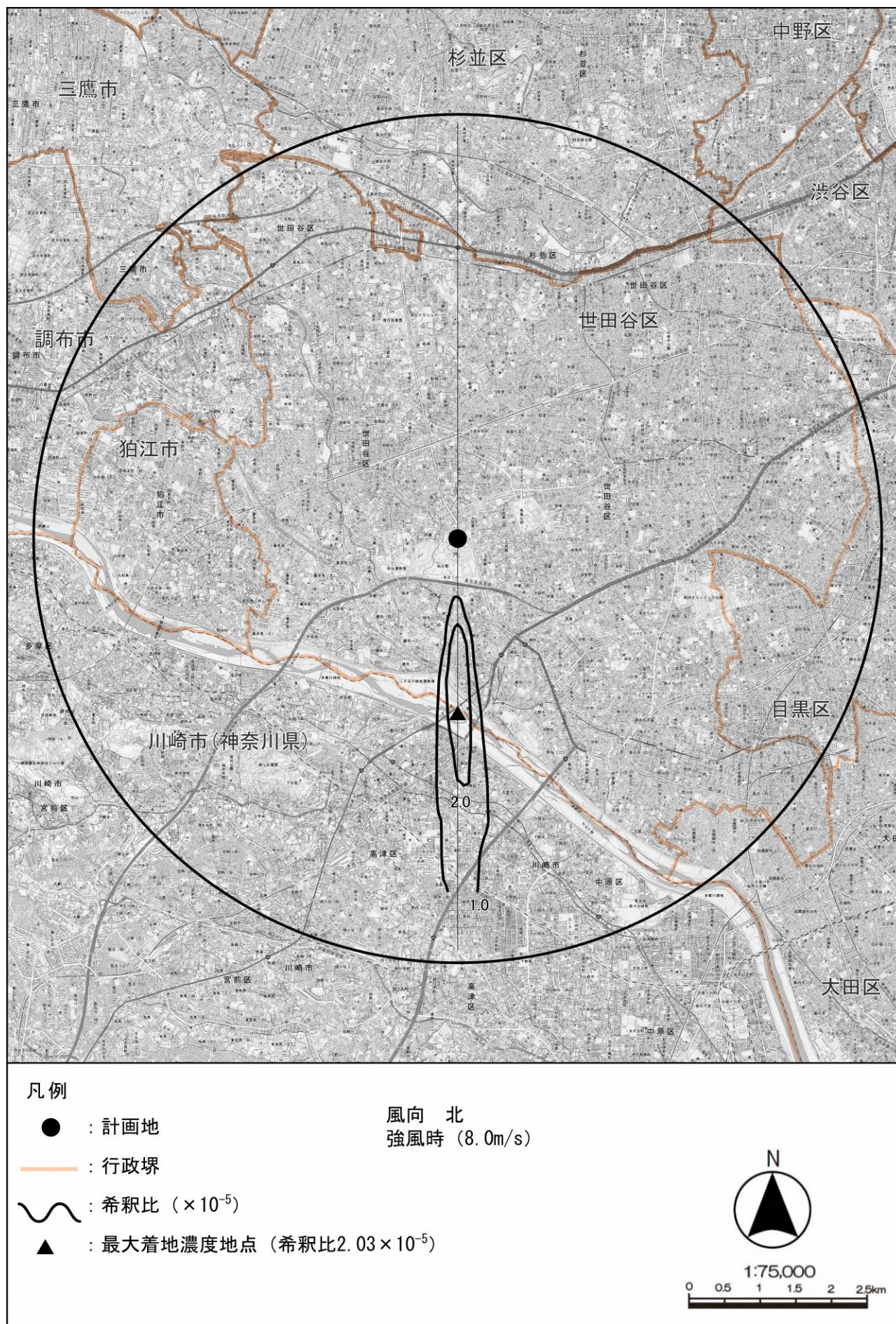
図 8.1-27 地形地表濃度コンター（風向北、風速 8.0m/s）
