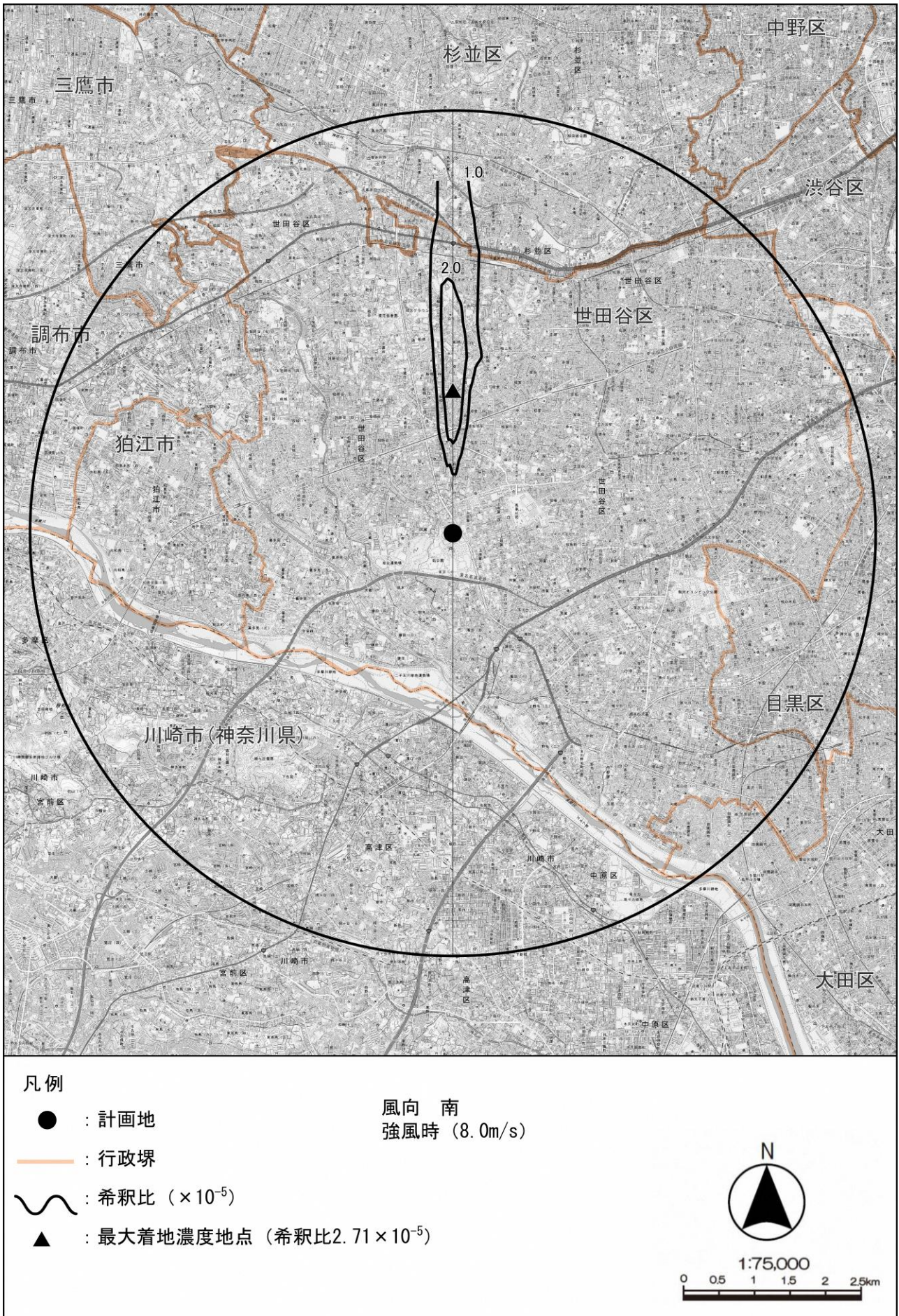
図 8.1-31 地形地表濃度コンター（風向南、風速 8.0m/s）
