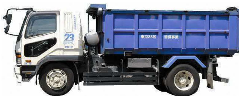
図 4.2-3 灰等運搬車両の外観（大型ダンプ車天蓋付 10m 3 ）
