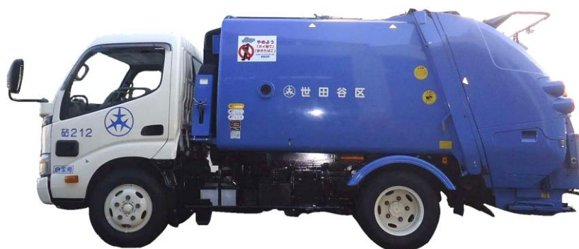
図 4.2-2 ごみ収集車両の外観（小型プレス車 4 m 3 ）
