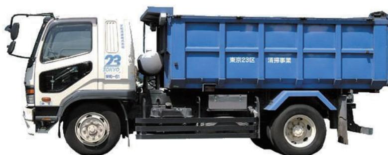
図 4-17 灰等運搬車両の外観（大型ダンプ車天蓋付 10m<sup>3</sup>）
