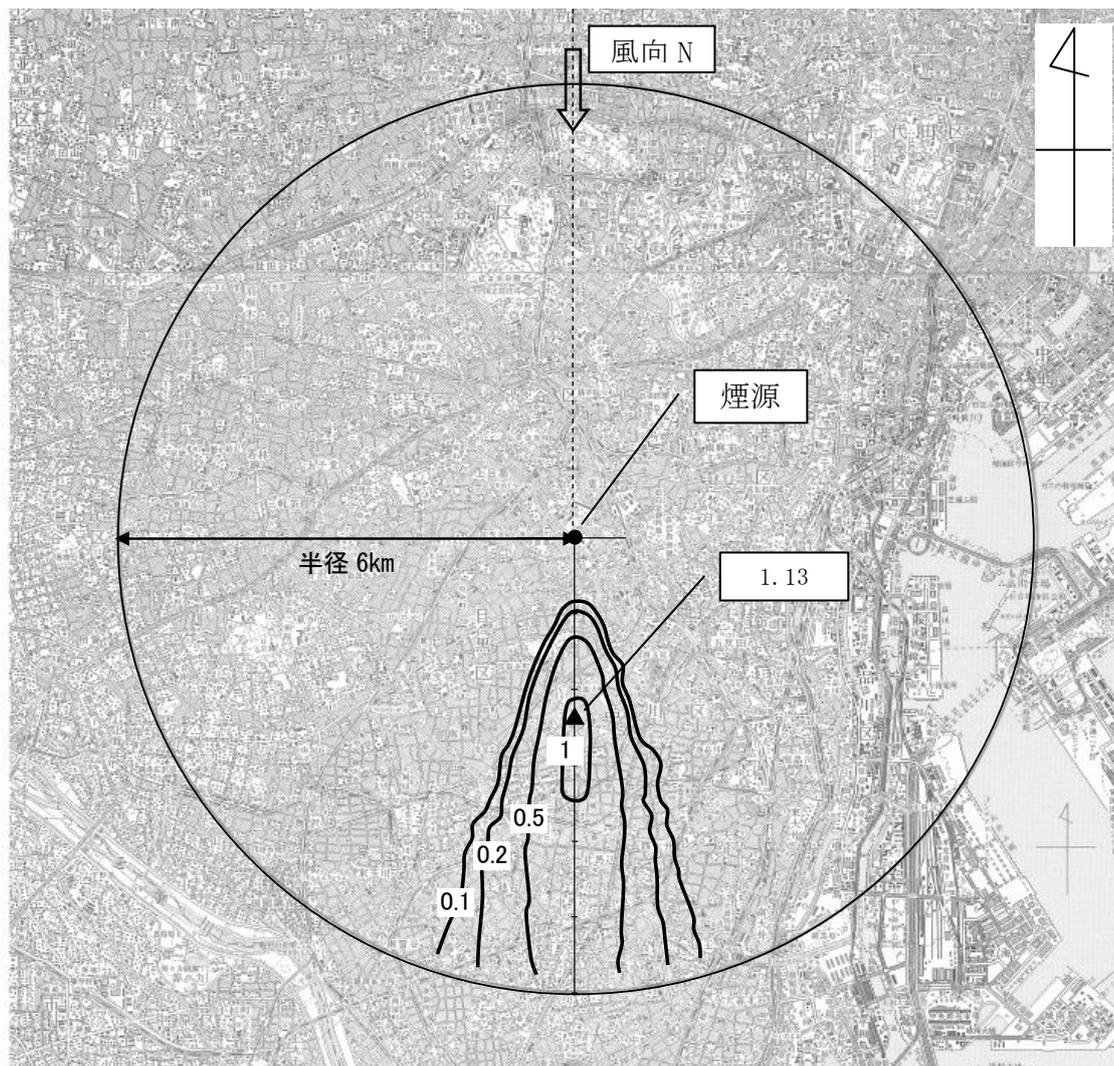
図 8.1-28 地形地表濃度コンター（風向北、風速 8.0m/s）
