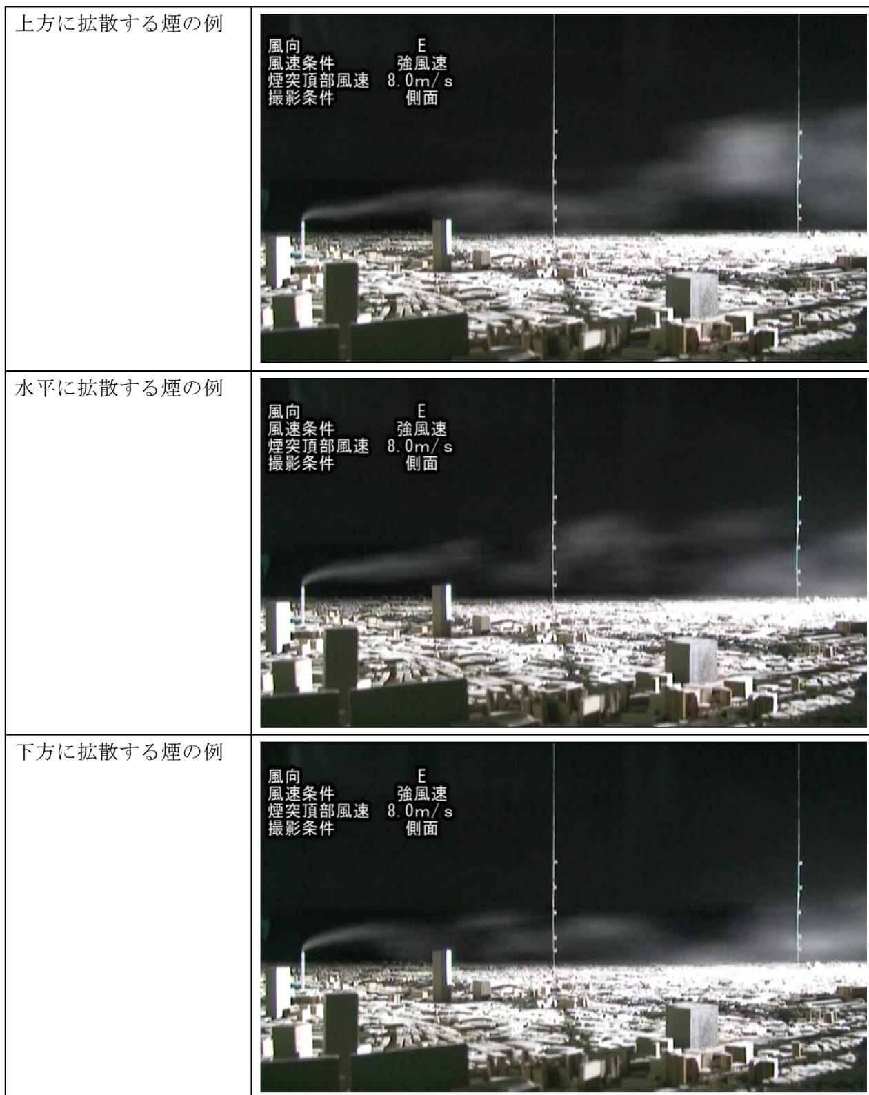
図 8.1-35 (2) 煙流し実験結果（風向東、強風時 8.0m/s）
