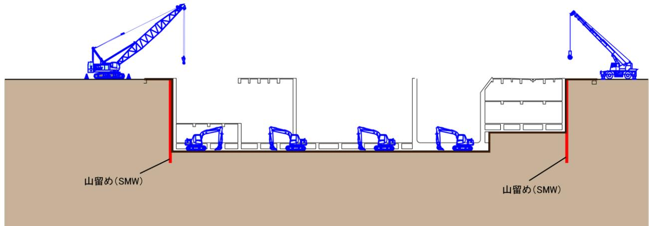
図 6.3-3 掘削工事の工事概念
