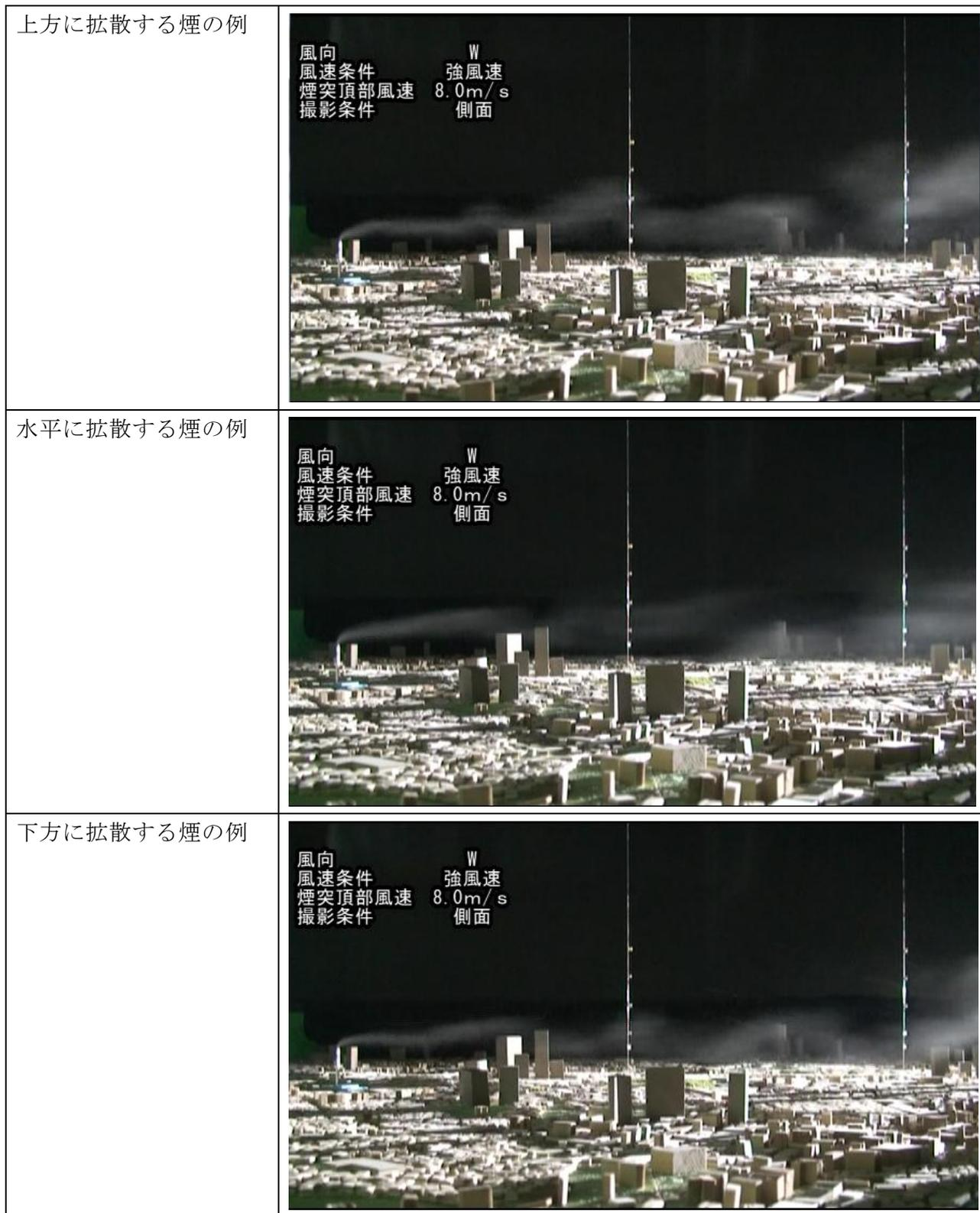
図 8.1-35 (4) 煙流し実験結果（風向西、強風時 8.0m/s）
