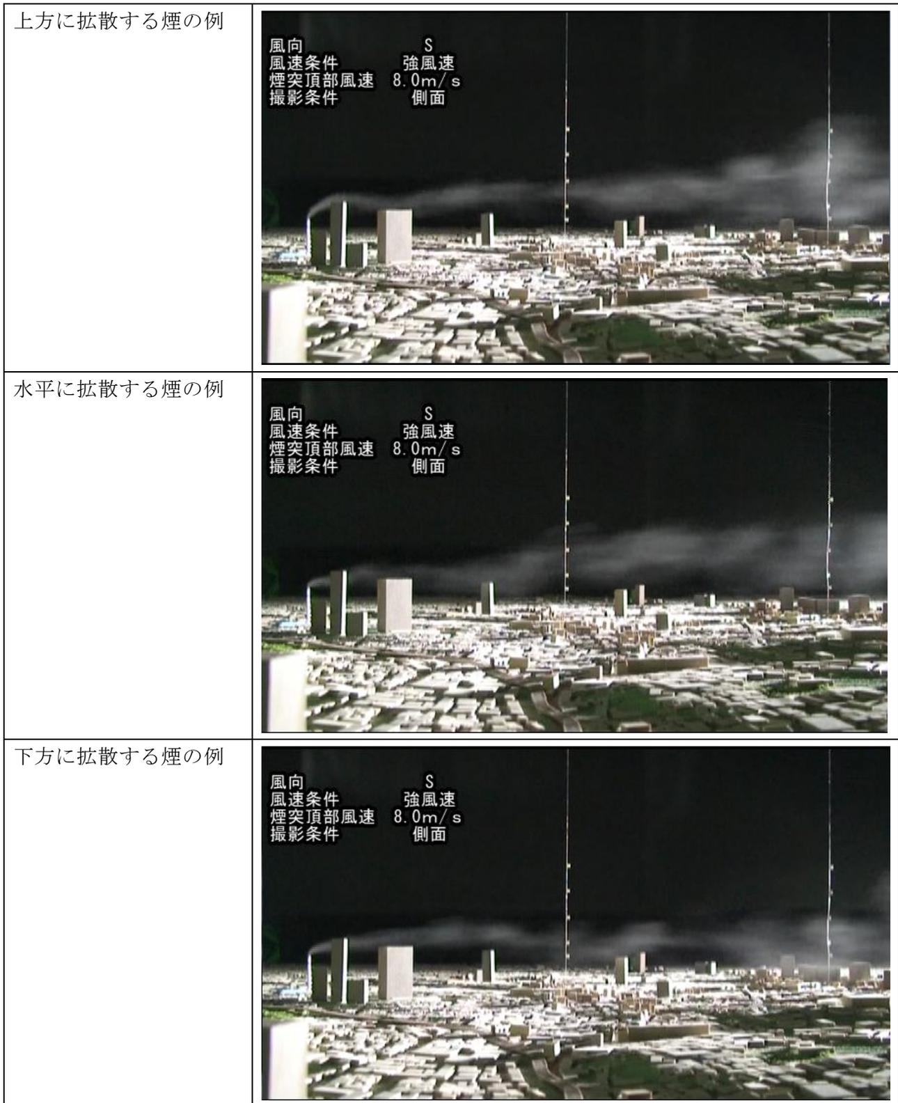
図 8.1-35 (3) 煙流し実験結果（風向南、強風時 8.0m/s）
