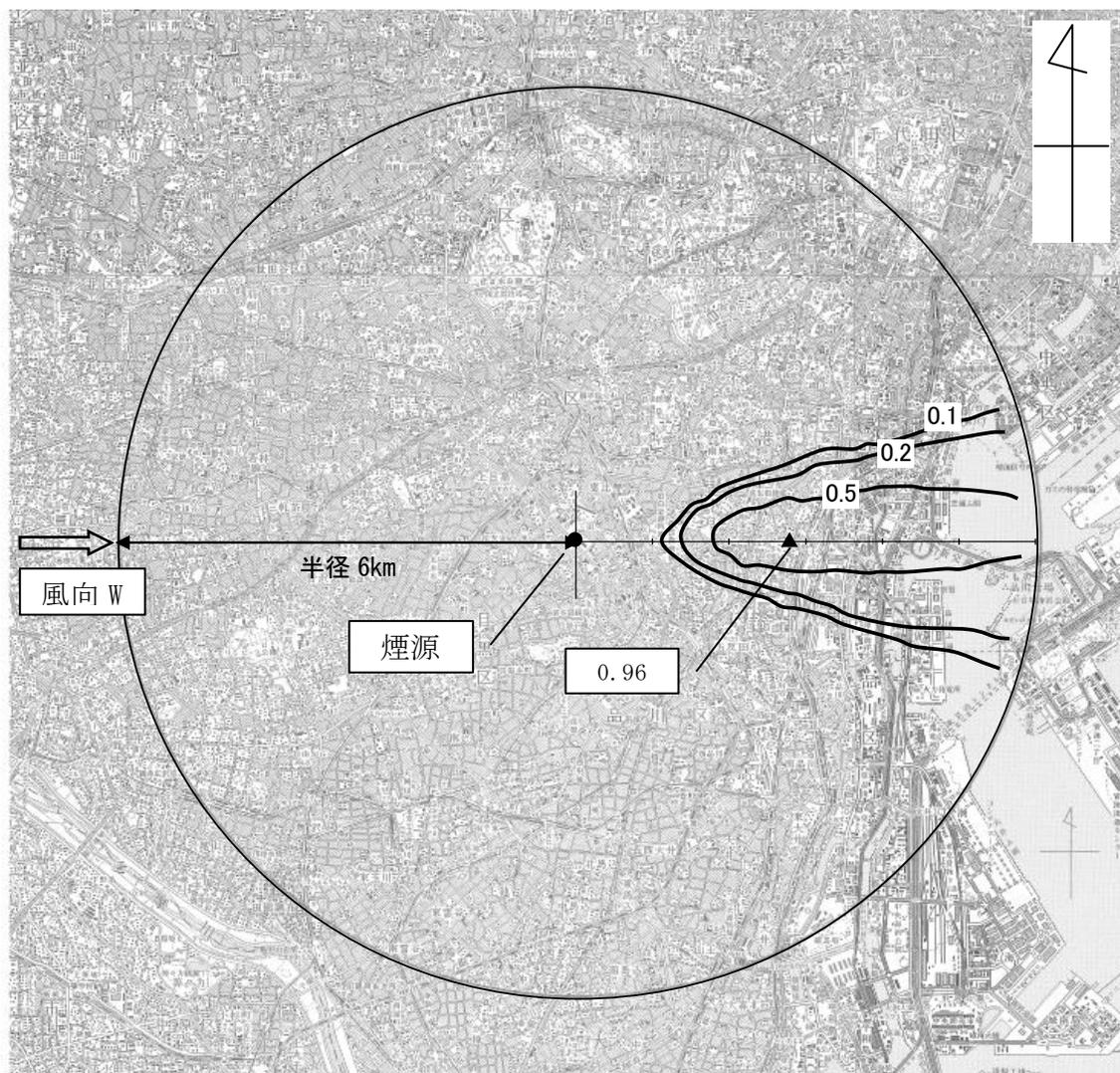
図 8.1-34 地形地表濃度コンター（風向西、風速 8.0m/s）
