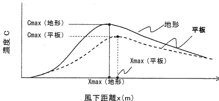
図 8.1-14 地表煙軸濃度分布のイメージ
