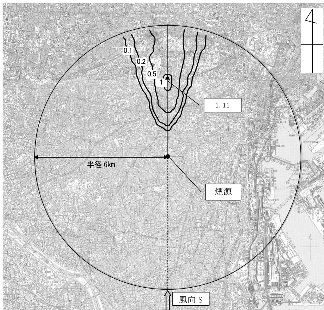
図 8.1-31 地形地表濃度コンター（風向南、風速 4.9m/s）
