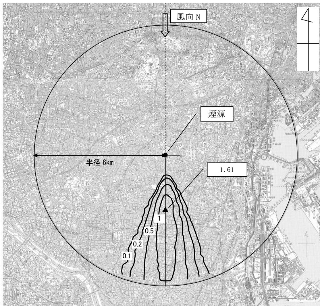
図 8.1-27 地形地表濃度コンター (風向北、風速 4.9m/s)
