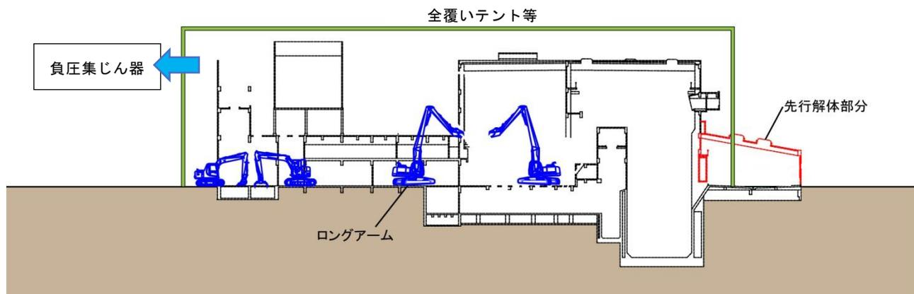
図 6.3-1 解体工事の工事概念
