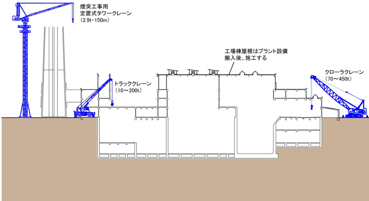
図 6.3-4 地上く体・仕上工事の工事概念
