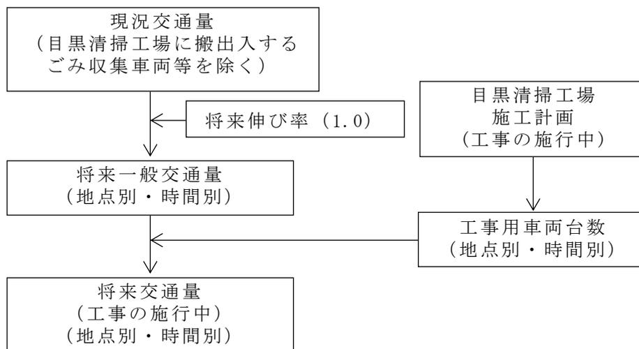
図 6.3-6 工事の施行中における将来交通量の推計フロー
