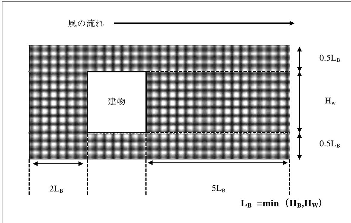
( $L_B$  : 建物高さ  $H_B$  と風向に直角な面への建物の投影幅 ( $H_W$ ) のいずれか小さい方の長さ)
