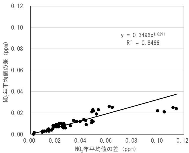
図 8.1-6 自動車の寄与による窒素酸化物と二酸化窒素の散布図
