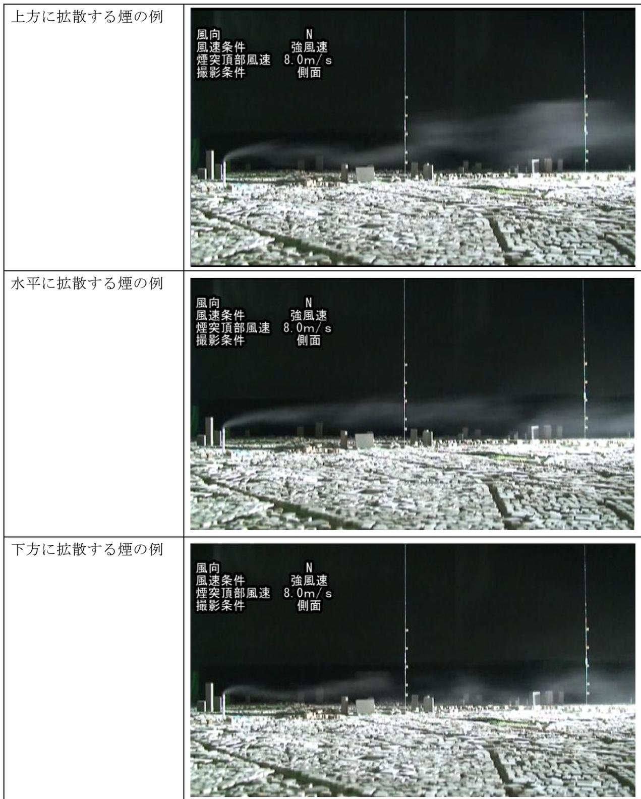
図 8.1-35 (1) 煙流し実験結果（風向北、強風時 8.0m/s）
