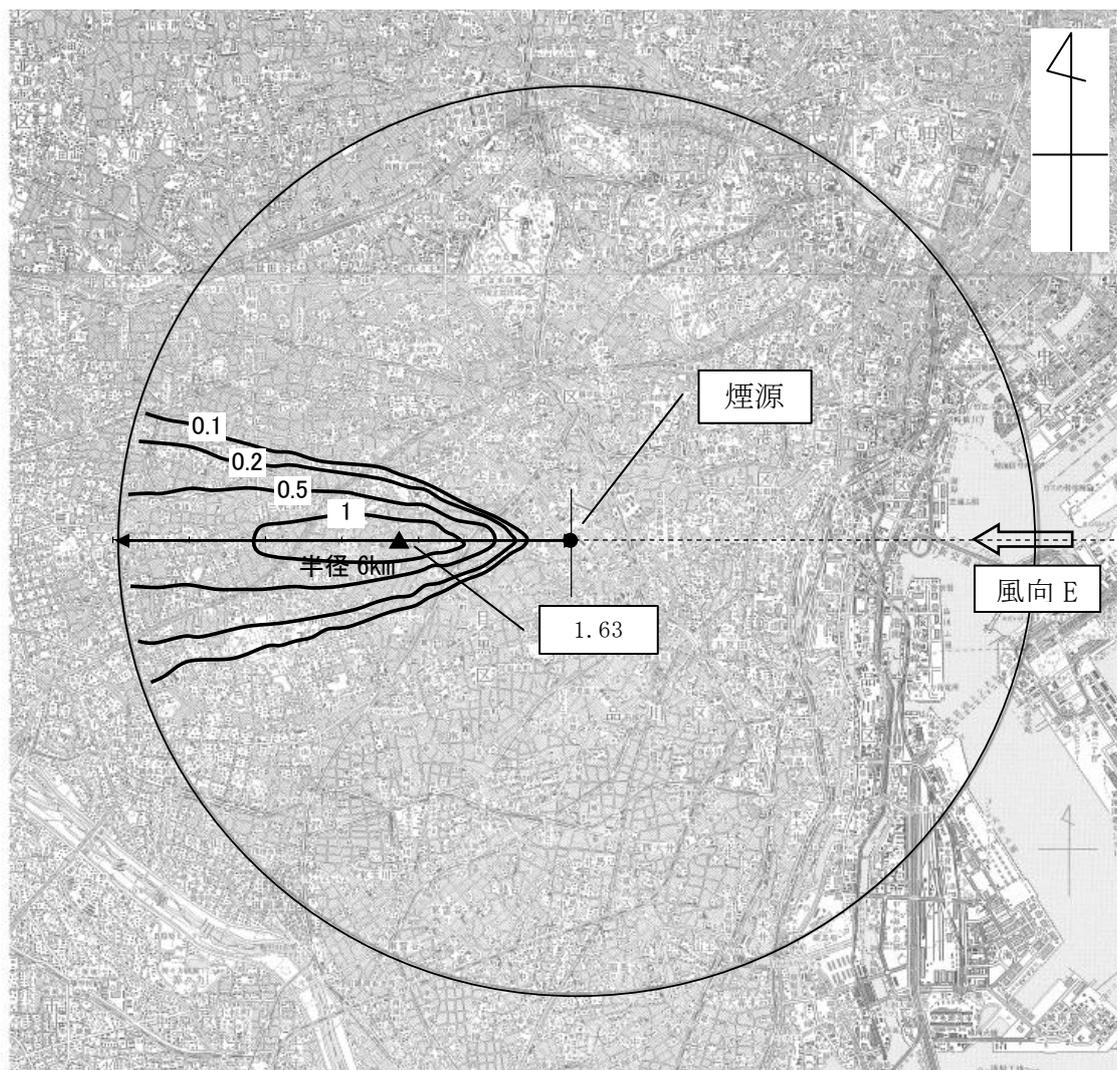
図 8.1-30 地形地表濃度コンター（風向東、風速 8.0m/s）
