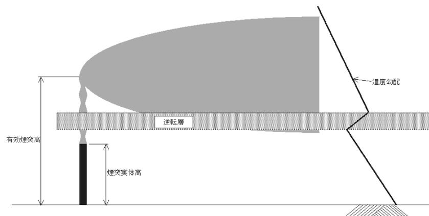
図 8.1-10 煙突排出ガスが逆転層を突き抜ける場合のイメージ図
