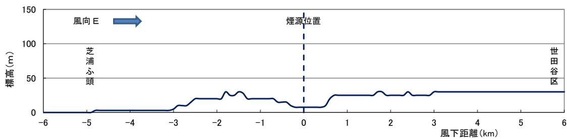
図 8.1-22 地形地表軸煙軸濃度分布（風向東、風速 8.0m/s）
