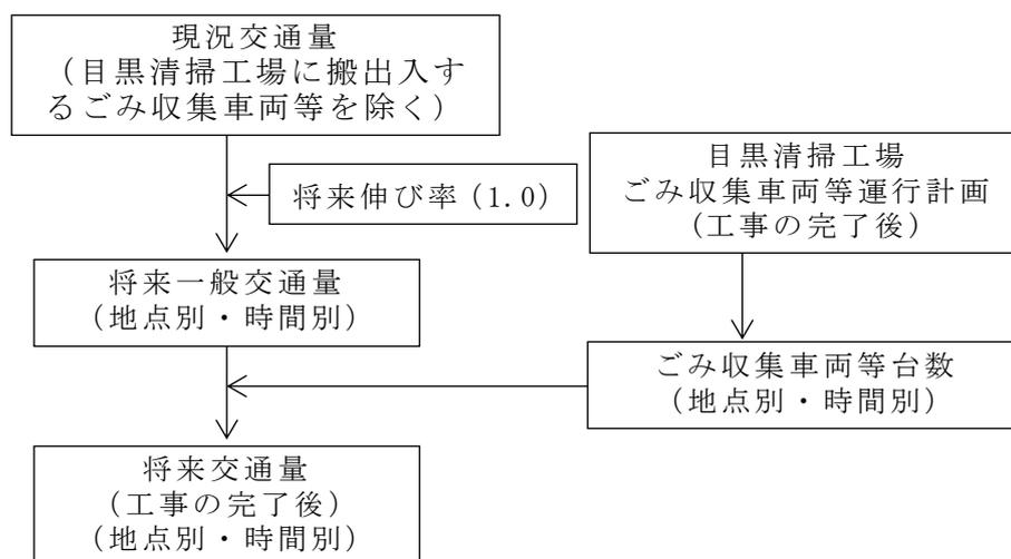
図 6.3-7 工事の完了後における将来交通量の推計フロー
