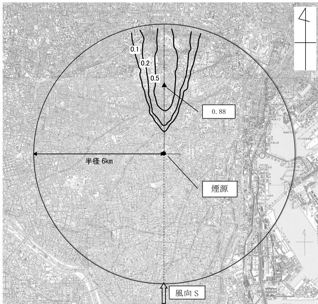
図 8.1-32 地形地表濃度コンター（風向南、風速 8.0m/s）
