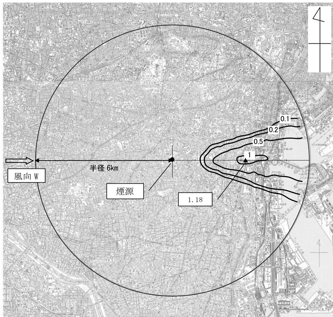
図 8.1-33 地形地表濃度コンター (風向西、風速 4.9m/s)
