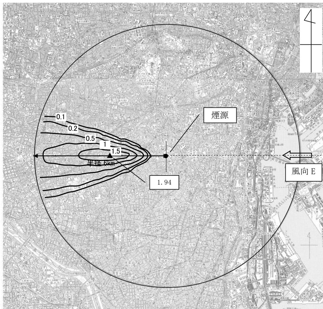
図 8.1-29 地形地表濃度コンター（風向東、風速 4.9m/s）
