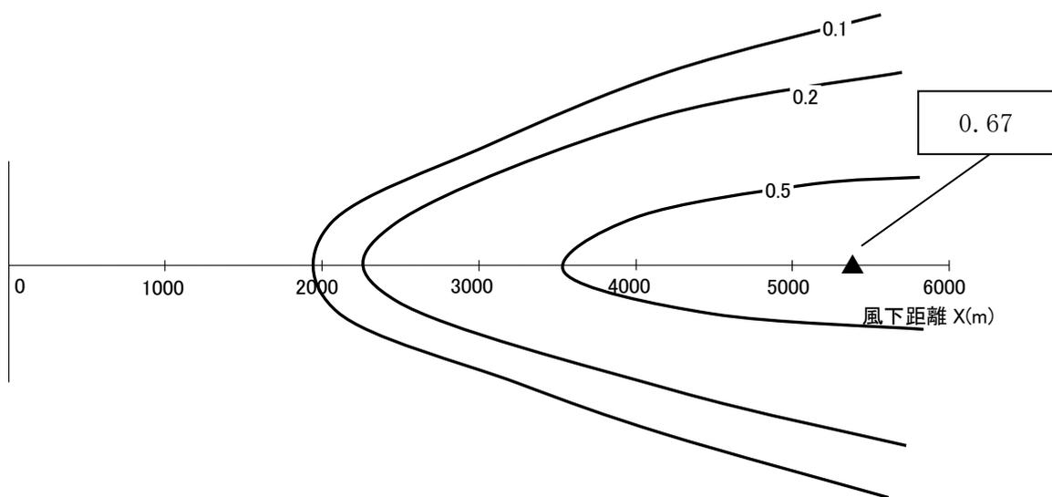
図 8.1-17 地表煙軸濃度分布 (上) 及び地表濃度コンター (下)
