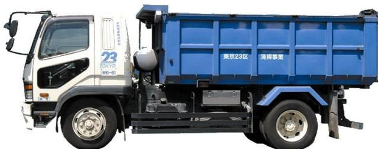
図 4-17 灰等運搬車両の外観（大型ダンプ車天蓋付 10m<sup>3</sup>）
