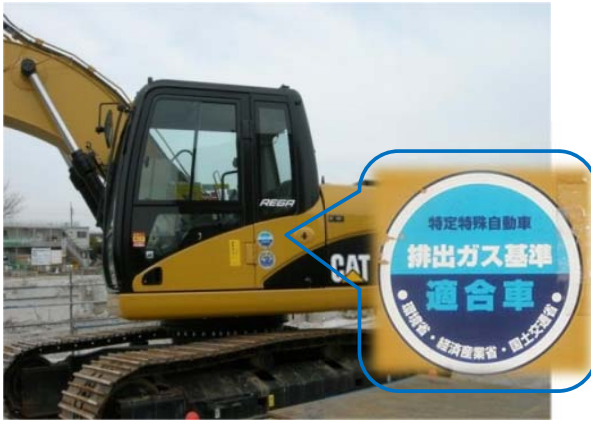
▲建設機械の排ガス対策
