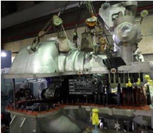
【蒸気タービンの開放点検(発電設備)】
